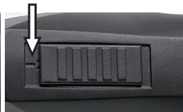
II. 5 Interruptor em posição ON ("I")
